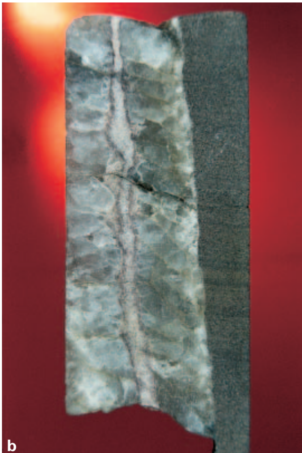
Abb. 23: Spatmineralisationen in Bohrungen der Altmark. a. Bohrung Mellin 8/71; KM 1954,9-1976,6 m; 3,9-4,0 m v. Ko. Grobspätiger Baryt in Rotliegend-Siltstein. Das Nebenstein weist keine Alterationsspuren auf (Länge des Stücks ca. 11 cm). b. Bohrung Winkelstedt 15/73; KM 3810,7-3823,0; 1,35-1,50 m v. Ko. Bilateral symmetrisches Fluorit-Trum mit jüngerem Baryt in der Mitte, randlich unveränderter Sandstein des Oberrotliegenden (Länge des Stücks ca. 15 cm).
