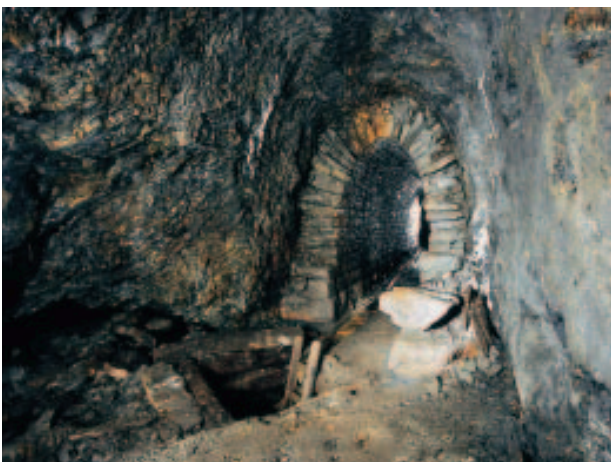
Abb. 14: Im Altbergbau der Grube Büchenberg. Derartige Strecken wurden in der Mitte des 19. Jahrhunderts zum planmäßigen Aufschluss der Eisenerze aufgefahren. Sie ermöglichten eine deutliche Produktionssteigerung (Foto J. KRUSE, Elbingerode).
